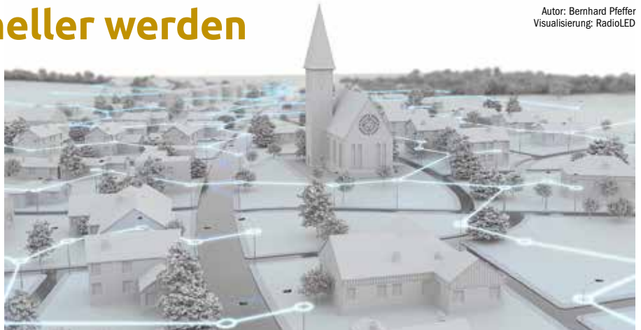
Durch Sendestationen auf Straßenlaternen soll die Internetgeschwindigkeit in Saalfelden auf 100 Mbit/s erhöht werden.
